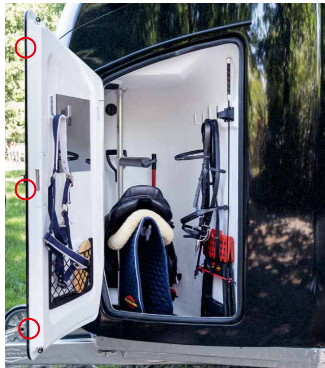
Optimaal afsluiten dankzij de driepunts-vergrendeling en de rubberafdichting.
