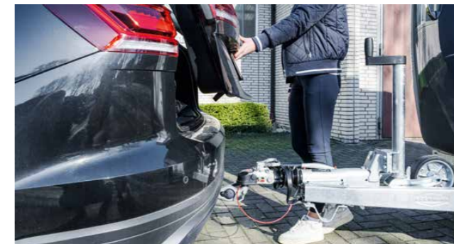
Ongehinderde toegang tot de kofferbak dankzij de met rubber ommantelde, comfortabele hartgreep van de koppeling en de platte remhendel – ook wanneer aangekoppeld.
