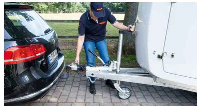
Gemakkelijk rangeren dankzij het automatische steunwiel, extra lang met handzame zwengel en optimaal geplaatste rangeergreep, ook bij koud weer perfect te bedienen.
