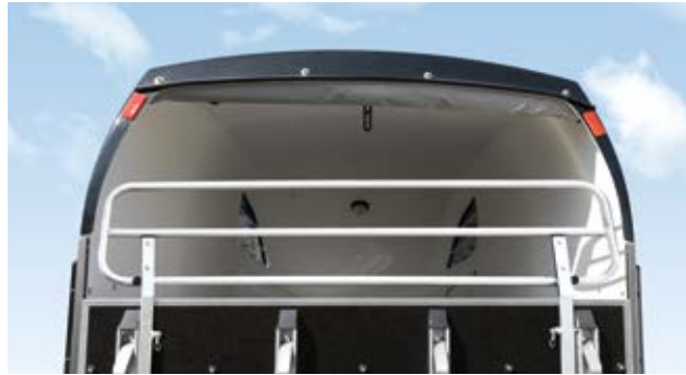
La sécurité sur la route grâce à une grille rabattable pour poulains.
