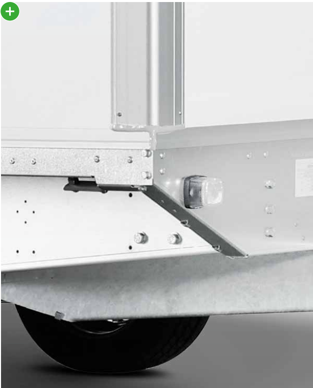
Eckwinkel Verschraubte, eloxierte Aluminium-Eckwinkel sorgen für eine hohe Verwindungssteifigkeit.
