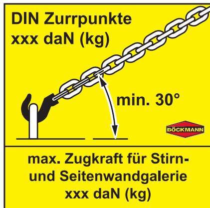
Fig. 5: Fastsurringspunkter på traileren
