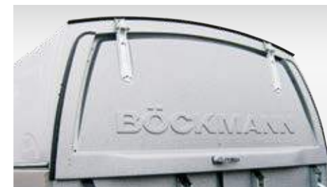
Hayon arrière verrouillable en polyester équipé d'amortisseurs (sauf sur Uno, Duo Pony, Duo Isy et Traveller) Afsluitbare polyester-achterklep met schokbrekers uitgerust (behalve Uno, Duo Pony, Duo Isy en Traveller)
