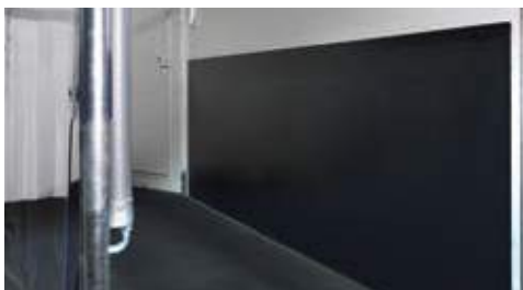
Durable thanks to kick protection (composite) on side walls Lang levetid grunnet sparkebeskyttelsen (plast) på sideveggene
