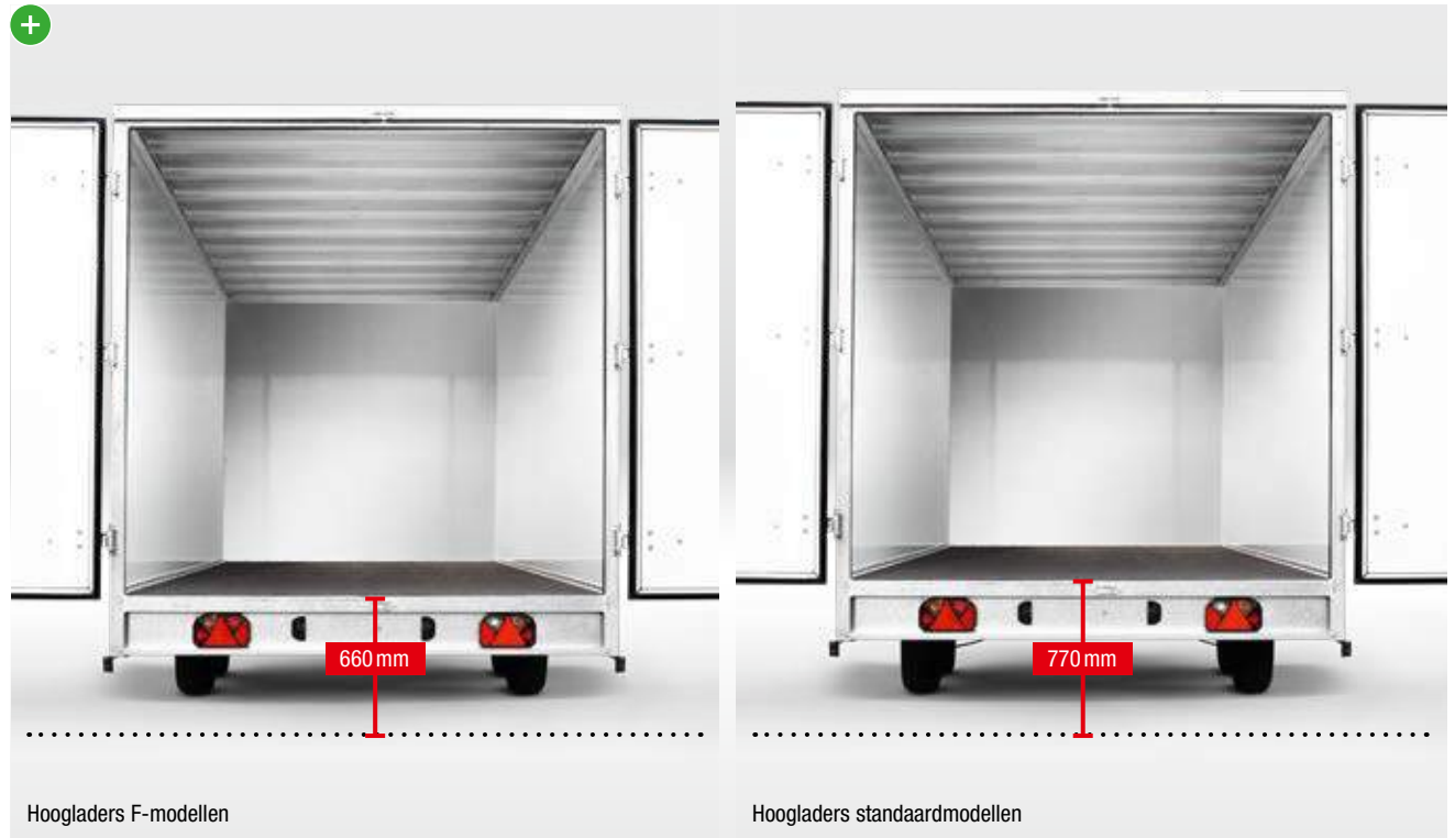
Laadhoogtes Om het laden en lossen van de gesloten aanhangwagens bijzonder gemakkelijk te maken hebben de F-modellen een lage laadhoogte vanaf 660 mm. Voor de standaardmodellen bedraagt deze tot 770 mm.
