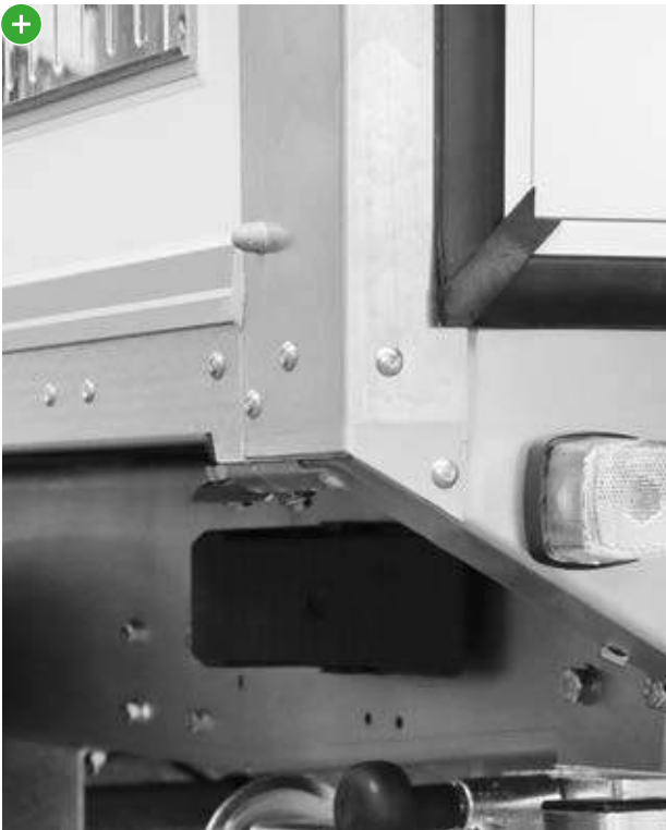
Hoeken Op het frame geklonken geanodiseerde aluminium hoeken zorgen voor een hoge torsiestijfheid.
