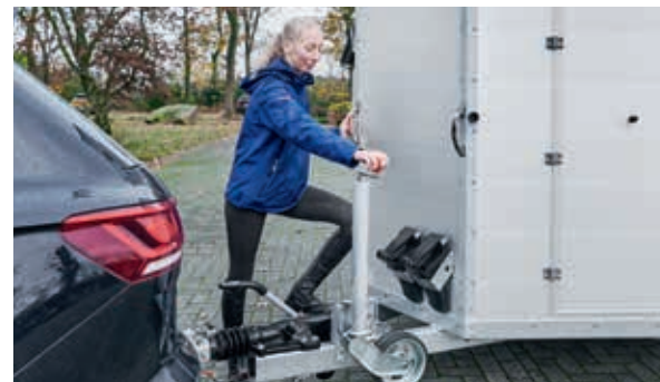
Utilisation facile au moyen de la roue jockey automatique pour charges lourdes (de série sur les modèles K4 Big SK, K5, W3 Big SK, W4 et G3) ou avec la roue jockey automatique, extra longue avec manivelle en plastique très maniable même par temps froid.
