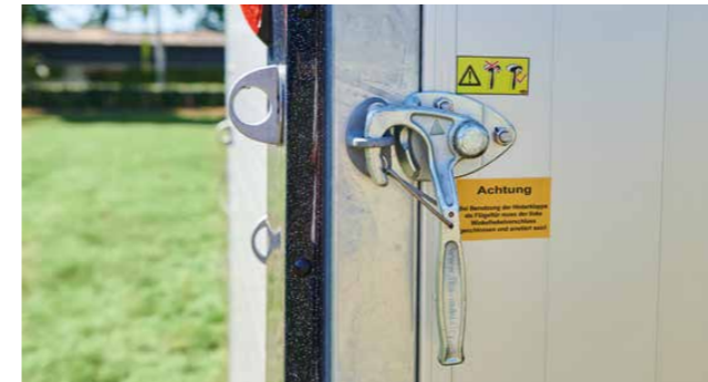
Veiligheid dankzij stabiele, 180° omklapbare winkelhaaksluitingen, waardoor uw paard minder risico loopt op verwondingen.
