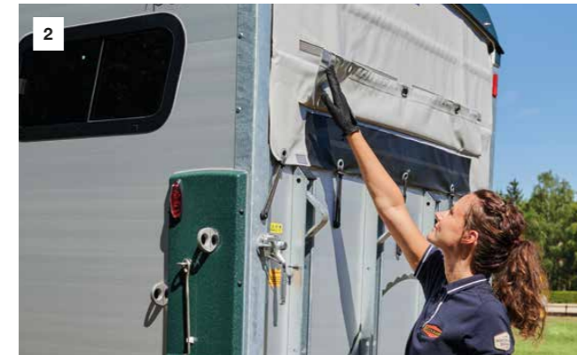
Zeillift met automatische oprolfunctie [1] en geïntegreerd net (niet bij de Big Portax-modellen) [2].
