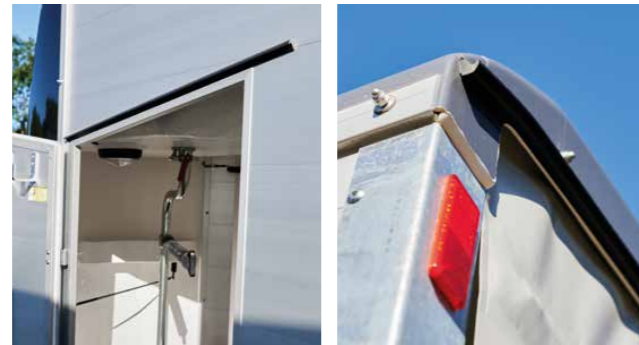
Bescherming tegen de regen dankzij de regenlijst boven de deuren en de achterkant.
