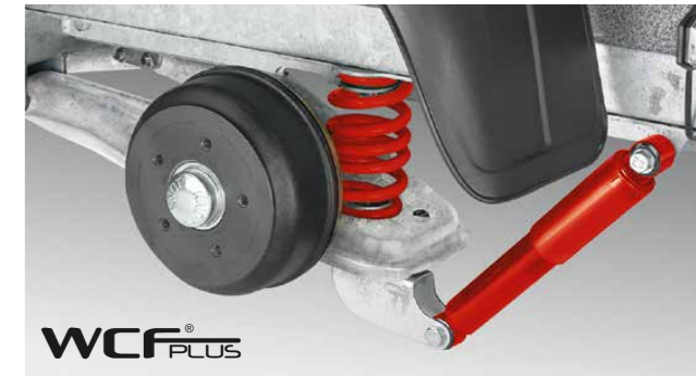
Rijcomfort dankzij het World-Class-chassis volgens automobieltstandaard met wiel-schokbreker en Tempo 100-ontheffing (geldt uitsluitend voor Duitsland).
