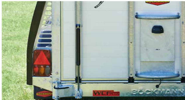
Pas de risque de sabots coincés grâce aux grilles dans les renforts.
