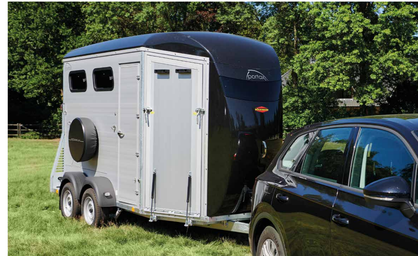
Facilité de traction grâce à sa conception aérodynamique et à son centre de gravité bas, pour une économie de carburant.
