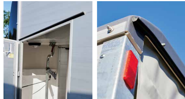
Protection anti-pluie grâce à des gouttières au-dessus des portes et au-dessus du pont.
