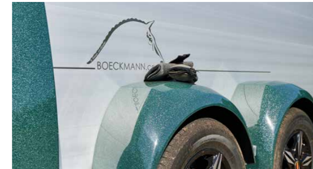
Garde-boue en guise de surface de rangement grâce à la forme large et droite en haut des garde-boues en plastyène ou en polyester résistant aux chocs.
