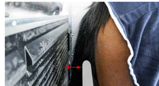
Espace suffisant pour la queue grâce au large écart entre la barre de sécurité et le pont arrière.
